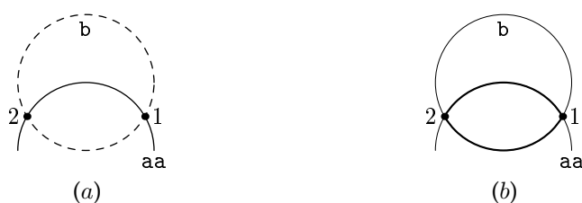
FIG. 8.3 – (a) Le chemin semi-circulaire aa et le chemin b en pointillé; (b) chemins aa et b et les parties sélectionnées par buildcycle , en ligne épaisse
